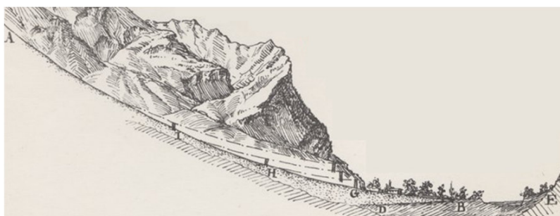
Figure 3. Site optimal de mise en œuvre d'une série de barrage de rétention (au point G) pour encourager un volume maximal de rétention dans la gorge, c'est-à-dire la zone située entre la tête de bassin (en amont de A) et le cône de déjection (en aval de G), plutôt que la dispersion des barrages (aux points I et H) stockant des volumes moindres (source Breton [11])
