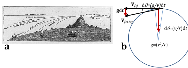
Figure 4. a) Mouvement d'un corps lancé avec une vitesse horizontale croissante, jusqu'à satellisation sur orbite circulaire (8000 m/s) et libération de la Terre (11 000 m/s) [Source : illustration de la théorie de Newton parue dans « l'Astronomie Populaire »]. b) Loi de la dynamique appliquée au mouvement circulaire d'un satellite : pendant un court intervalle de temps dt, le satellite tourne d'un angle dq=(v/r)dt , et le vecteur vitesse tourne du même angle d\theta=(g/v)dt , d'où on déduit g=(v^2/r) . C'est ce qui permet de calculer la vitesse de satellisation v=8000 \text{ m/s} à proximité de la surface terrestre ( r=6500 \text{ km} , g=9,81 \text{ ms}^{-2} ). L'accélération reste partout perpendiculaire à la vitesse le long de l'orbite circulaire.
