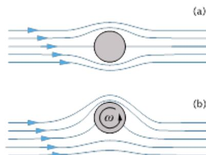
Figure 4. Cylindre circulaire placé dans un vent uniforme venant de la gauche, a) cylindre non tournant, b) cylindre tournant avec la vitesse angulaire  $\omega$ . [Source : © EDP Sciences, Grenoble sciences]
