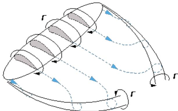
Figure 6. Allure schématique de l'écoulement autour d'une aile d'envergure finie, avec la présence d'un tourbillon d'intensité  $\Gamma$ , invariante tout au long du grand tube tourbillonnaire qui se referme à l'aéroport. [Source : © EDP Sciences, Grenoble sciences]
