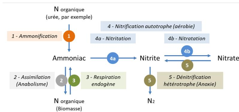
Figure 5. Voies de transformation de la pollution azotée dans une station d'épuration. [Source : © Joseph De Laet]
