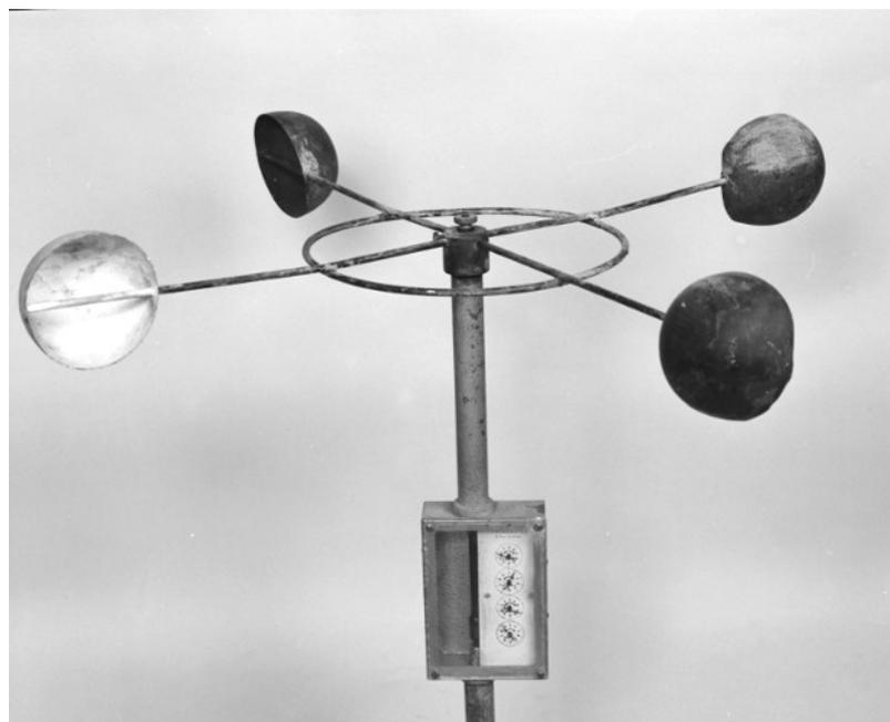
*Figure 7. Anémomètre Robinson à compteurs. [Source : © Météo-France].*
