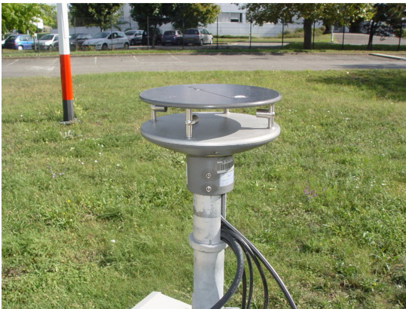
Figure 7. Exemple de capteur de vent à ultrasons [Source : © Lantuejoul Pierre – Météo-France]
