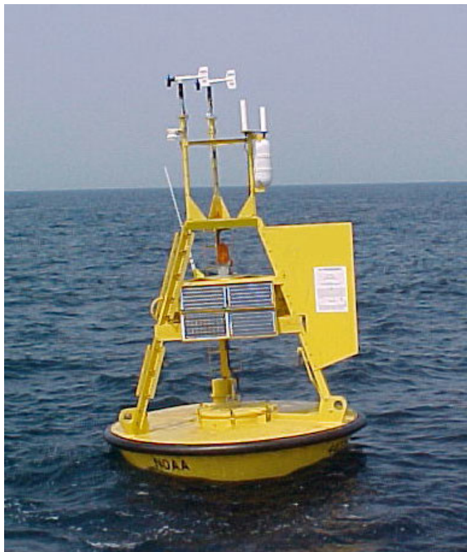
Figure 3. Bouée météorologique ancrée de 3 mètres de diamètre utilisée par l'agence météorologique américaine. Elle est en particulier équipée d'un thermomètre pour la mesure de la température de l'eau à la surface de la mer. [Source : Domaine public]
