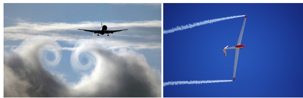
Figure 7. Illustration des tourbillons marginaux en bouts d'ailes. A gauche, l'enroulement de ces tourbillons engendrés par un avion gros porteur est rendu visible grâce au nuage situé au-dessous de lui. A droite, aux extrémités des ailes d'un planeur, ces tourbillons sont rendus visibles grâce à un phénomène de condensation localisé près de leur axe [Source : (image gauche) DR. (image droite) Pixabay].
