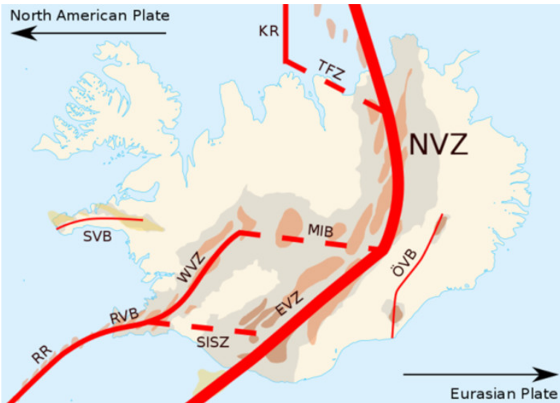
Figure 1. Localisation de l'Islande sur deux plaques tectoniques. L'emplacement de la dorsale médio-atlantique est indiqué ici par une ligne rouge en gras. Les principales zones volcaniques sont également indiquées. [Source: Psihedelisto (ajouter des lignes de faille), Chris.urs-o (aperçu de l'Islande)] [CC BY-SA ( https://creativecommons.org/licenses/by-sa/3.0 )]
