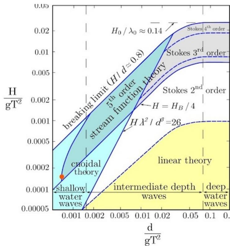
Figure 4. Domaine d'existence des différents types de houles. En fonction de la profondeur  $h$ , hauteur de la vague  $H$ , période temporelle de la vague  $\tau$  et pesanteur  $g$ . [Source : Kraaiennest, [CC BY-SA 3.0](https://commons.wikimedia.org/wiki/File:Stokes_wave_theory_domains.png), via Wikimedia Commons]
