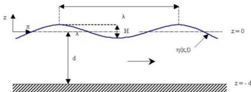
Figure 2. Houle sinusoïdale. Le déplacement vertical de la surface libre s'exprime en fonction de la position  $x$  et du temps  $t$  comme  $\eta(x,t) = (H/2) \sin[2\pi(x/\lambda - t/T)]$  [Source : auteur]
