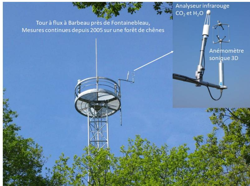
Figure 11. Mesures des flux de  $\text{CO}_2$  et  $\text{H}_2\text{O}$  au-dessus d'une forêt [Source : © J-Y Pontailier, LEV Orsay]
