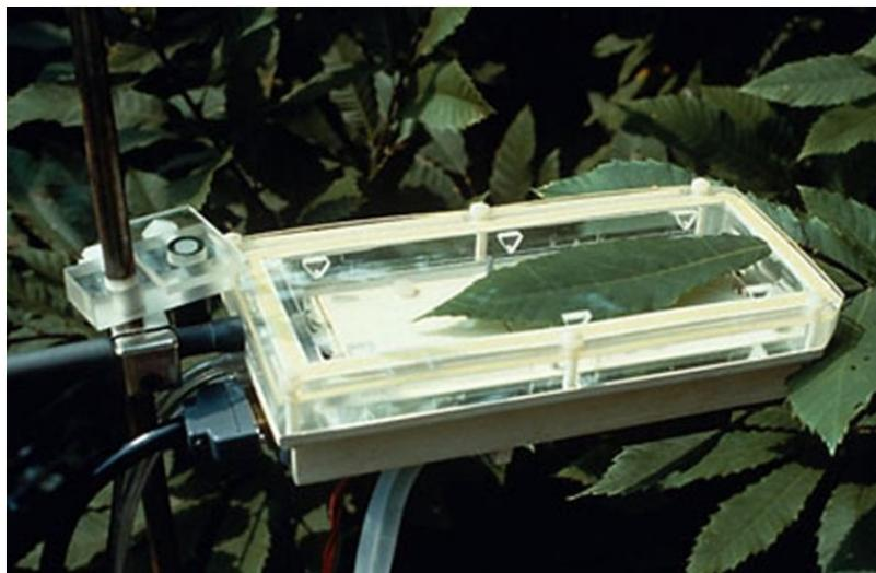
Figure 8. Chambre permettant de mesurer *in situ* la résistance stomatique et les échanges de  $CO_2$  et d' $H_2O$  sur une feuille non coupée [Source : © J-Y Pontailler, LEV Orsay]
