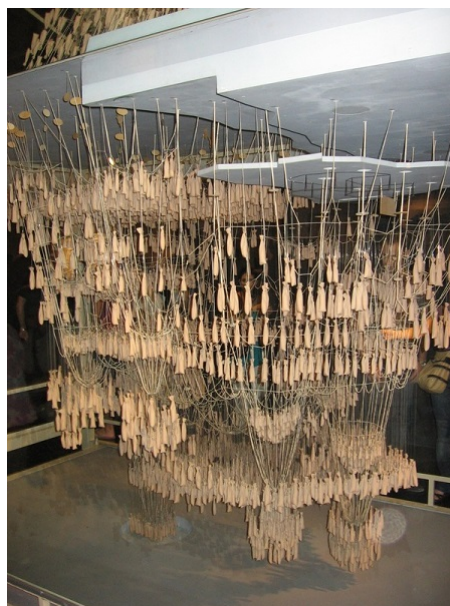
Figure 2. Maquette inversée de la cathédrale Sagrada Familia de Gaudi. La forme d'équilibre est telle qu'à chaque intersection de fils la somme vectorielle des forces est égale à zéro. Chaque élément de poutre est représenté par un fil, et sa masse simulée par un poids. La force de tension sur un fil est nécessairement alignée avec le fil. Dans la configuration réelle inversée, la force correspondante sera alors une force de compression alignée le long de la poutre, ce qui en garantit la tenue mécanique. [Source : http://olive-art.weebly.com/uploads/2/6/0/5/26053332/6555663_orig.jpg ].
