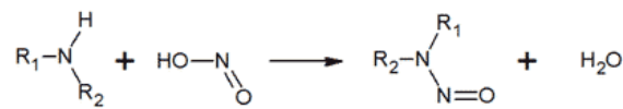
Figure 5 : la production de nitrosamine par réaction du nitrite (HNO 2 ) sur un composé aminé secondaire (R 1 R 2 -NH). [Paulo 807, (CC BY-SA 4.0) via Wikimedia Commons]
