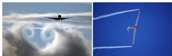
Figure 7. Illustration des tourbillons marginaux en bouts d'ailes. A gauche, l'enroulement de ces tourbillons engendrés par un avion gros porteur est rendu visible grâce au nuage situé au-dessous de lui. A droite, aux extrémités des ailes d'un planeur, ces tourbillons sont rendus visibles grâce à un phénomène de condensation localisé près de leur axe [Source : (image gauche) DR. (image droite) Pixabay].
