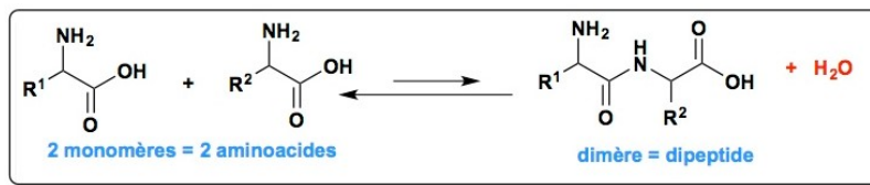
Figure 3. Synthèse d'un dipeptide à partir de deux aminoacides. La différence de longueur des flèches signifie que l'équilibre est déplacé vers les deux aminoacides. La formation d'eau, en particulier, défavorise la synthèse du dipeptide.
