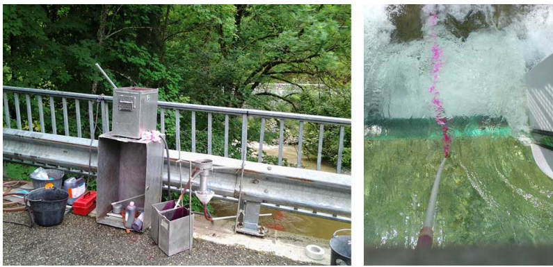
Figure 9. A gauche : dispositif d'injection de rhodamine. A droite : entrée de la rhodamine dans le torrent. Le traceur (inoffensif vis-à-vis de la faune et la flore) ne colore pas l'eau. Sa dilution s'analyse ensuite par un fluorimètre (mesurant l'atténuation de sa fluorescence), aujourd'hui encore au laboratoire ; demain peut être directement sur le terrain (crédit photo EDF DTG)
