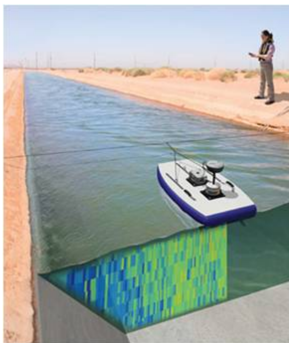
Figure 8. La mesure de vitesse par l'ADCP repose sur le principe du Doppler pulsé : émission d'impulsions ultrasonores dans l'eau et analyse du décalage fréquentiel de l'écho rétrodiffusé par les particules en suspension. Le dispositif comporte généralement 3 ou 4 transducteurs émettant des faisceaux acoustiques divergents autour de la verticale, ce qui permet de mesurer le profil vertical des vitesses en trois dimensions. [Source : crédit photo EDF DTG]
