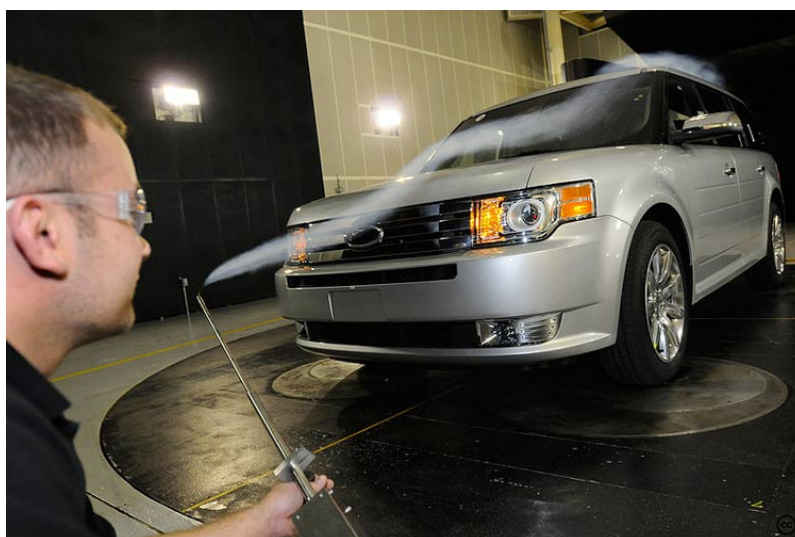
Figure 11. Dans une soufflerie, utilisation d'un gaz opaque pour visualiser l'influence de la forme de l'automobile sur l'écoulement et pour tester les possibilités de réduction du coefficient de traînée C_X . [Source : By Ford Motor Company from USA (Flex Aerodynamics) [CC BY 2.0 ( http://creativecommons.org/licenses/by/2.0 ) or CC BY 2.0 ( http://creativecommons.org/licenses/by/2.0 )], via Wikimedia Commons]
