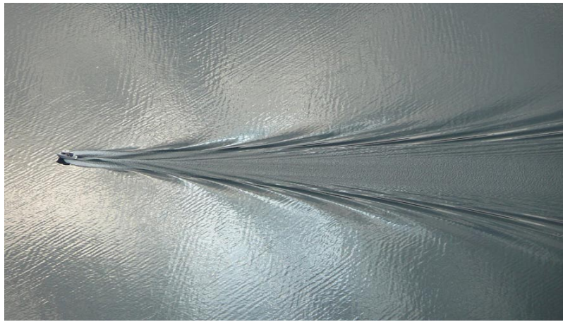
Figure 8. Sillage d'un bateau proche de la limite de Froude, pour laquelle la longueur d'onde des vagues est comparable à la longueur du bateau. [Source : By Edmont (Own work) [CC BY-SA 3.0 ( http://creativecommons.org/licenses/by-sa/3.0 ) or GFDL ( http://www.gnu.org/copyleft/fdl.html )], via Wikimedia Commons]
