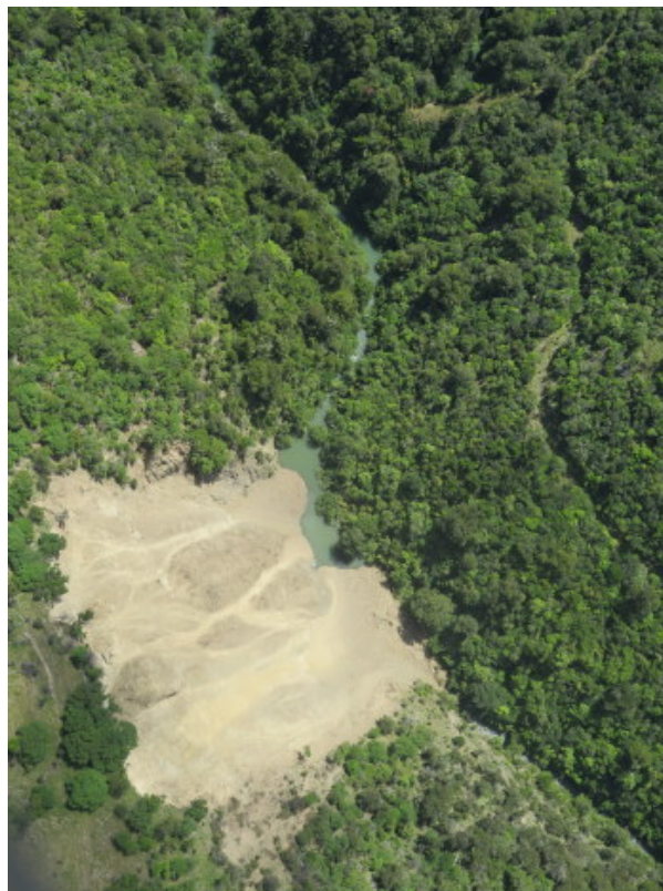
Figure 4. Barrage naturel et lac de barrage formés par obstruction du lit de la rivière Ote Makura par les débris d'un mouvement de terrain déclenché par le séisme du 14/11/2016 en Nouvelle-Zélande [Photo © GNS Science (CC BY 3.0 NZ)]
