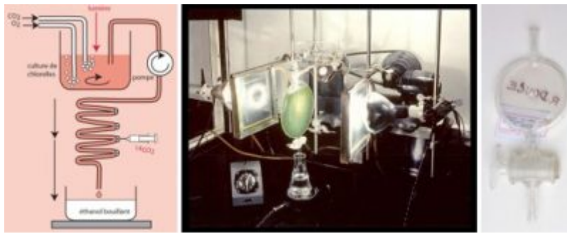
Figure 2. Schéma de l'appareillage utilisé pour suivre l'incorporation du carbone photosynthétique dans les produits de la photosynthèse . Au centre : dispositif utilisé pour l'étude de la fixation du CO 2 par des algues unicellulaires. [Source : Photo © Ernest O. Lawrence, Berkeley National Laboratory, Photography and Digital Imaging Services: previously unpublished, Biochemistry & Molecular Biology of Plants. B.B. Buchanan, W. Gruissem & R.L. Jones. American Society of Plant Physiologists, Rockville, MD. 2000 p. 610]. A droite : Lollipop donné au Pr. Roland Douce par Andrew A. Benson et conservé au Musée des Confluences (Lyon, France).
