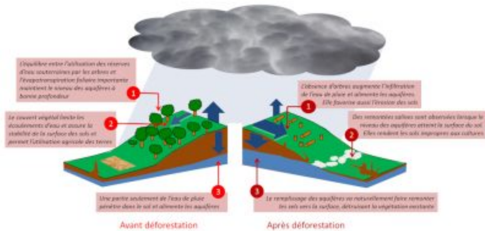
Figure 5. Salinisation secondaire. Exemple du bassin hydrographique de Murray-Darling (Australie). A gauche, le schéma illustre l'écosystème avant la déforestation où la forêt absorbe les précipitations ; ce qui empêche le remplissage des aquifères. Après la déforestation, les aquifères se remplissent et viennent à remonter entraînant du sel à la surface du sol (à droite). [Source : © Murray-Darling Basin Commission]
