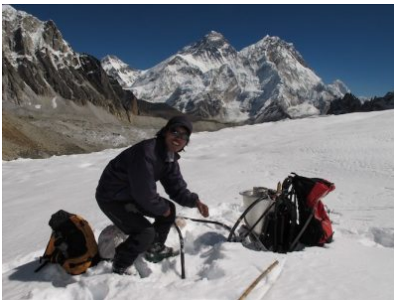
Figure 1. Installation d'une balise d'ablation en bambou à l'aide d'une sonde à vapeur dans la zone d'ablation du glacier West Changri Nup, sur fond d'Everest. [Source : © Patrick Wagnon]
