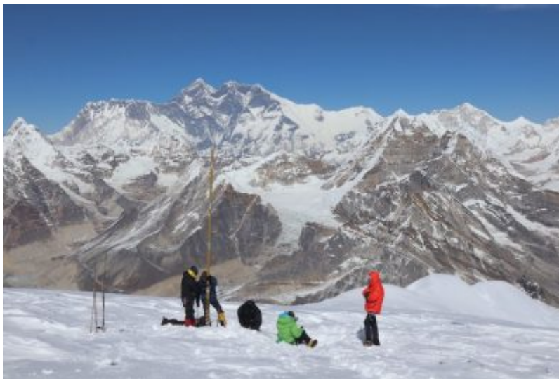
Figure 2. Mesure du bilan de masse ponctuel à l'aide d'un carottier doublé de mesures de densité dans la zone d'accumulation du glacier Mera à 6350 m d'altitude, sur fond d'Everest. [Source : © Bruno Jourdain].
