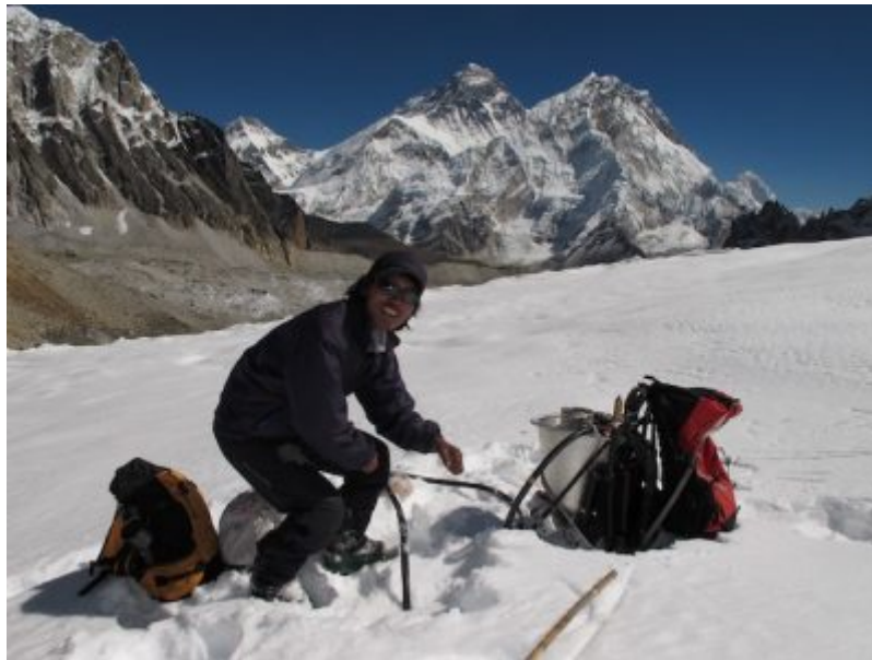
Figure 1. Installation d'une balise d'ablation en bambou à l'aide d'une sonde à vapeur dans la zone d'ablation du glacier West Changri Nup, sur fond d'Everest. [Source : © Patrick Wagnon]
