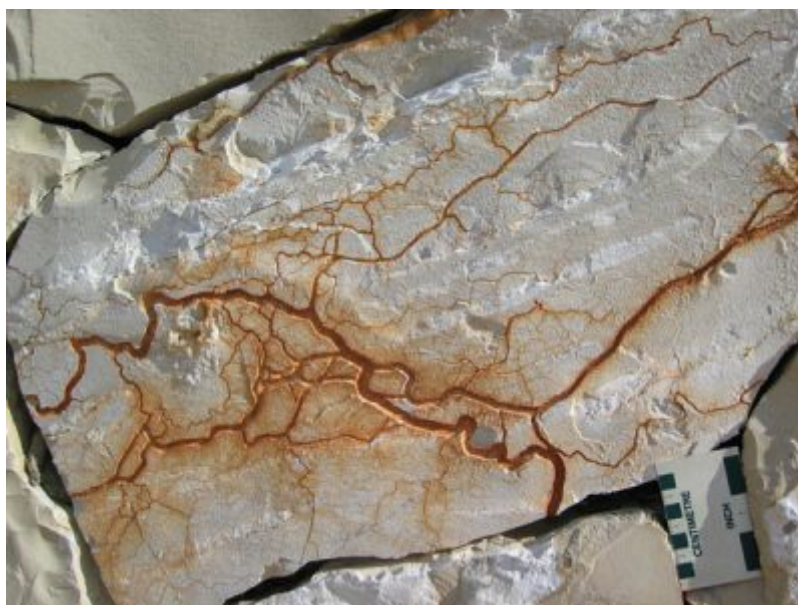
Figure 1. Réseau de fissures et marques de racines dans l'épikarst. [Source : Photo M. Bakalowicz]
