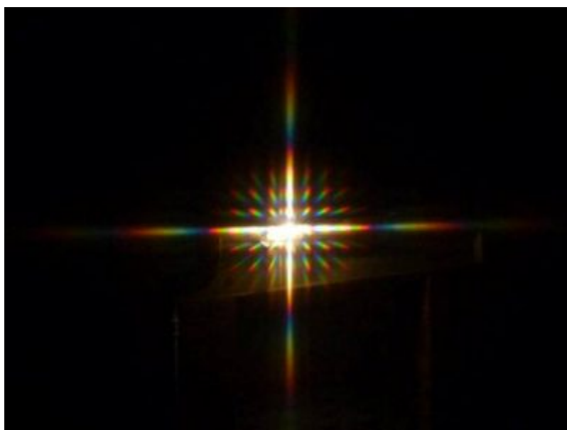
Figure3. Diffraction d'une lumière polychromatique par un orifice circulaire. La tache centrale est blanche en raison de la superposition de toutes les longueurs d'ondes. Les taches périphériques représentent tout le spectre des couleurs du visible, le décalage des diverses longueurs d'ondes étant de plus en plus grand lorsqu'on s'éloigne du centre. [Source : Superprof, Article "Tout savoir sur la diffraction", disponible sur : " https://www.superprof.fr/ressources/physique-chimie/terminale-s/optique/diffraction.html "]
