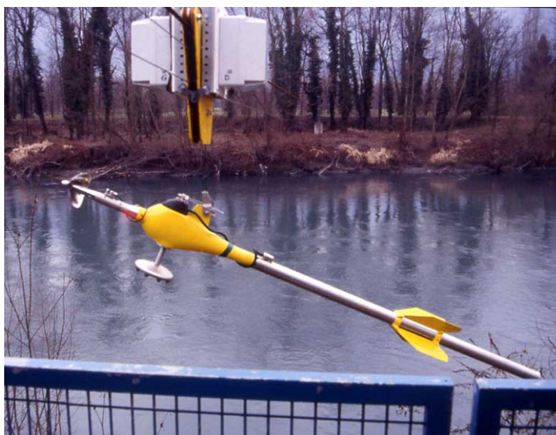
Figure 6. Moulinet hydrométrique mis en œuvre à la station de Grenoble Campus sur l'Isère [Source : crédit photo LTHE]
