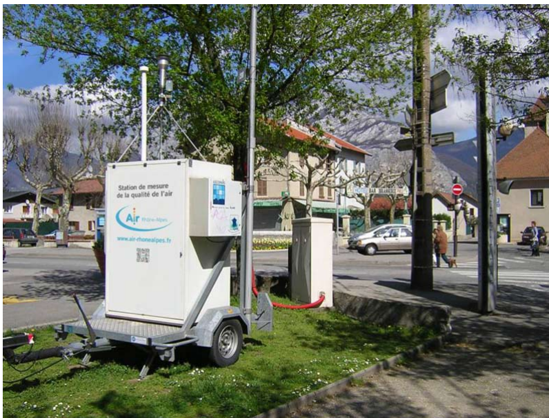
Figure 8. Station mobile en proximité trafic [Source : Atmo Auvergne-Rhône-Alpes : http://www.air-rhonealpes.fr/phototheque ]
