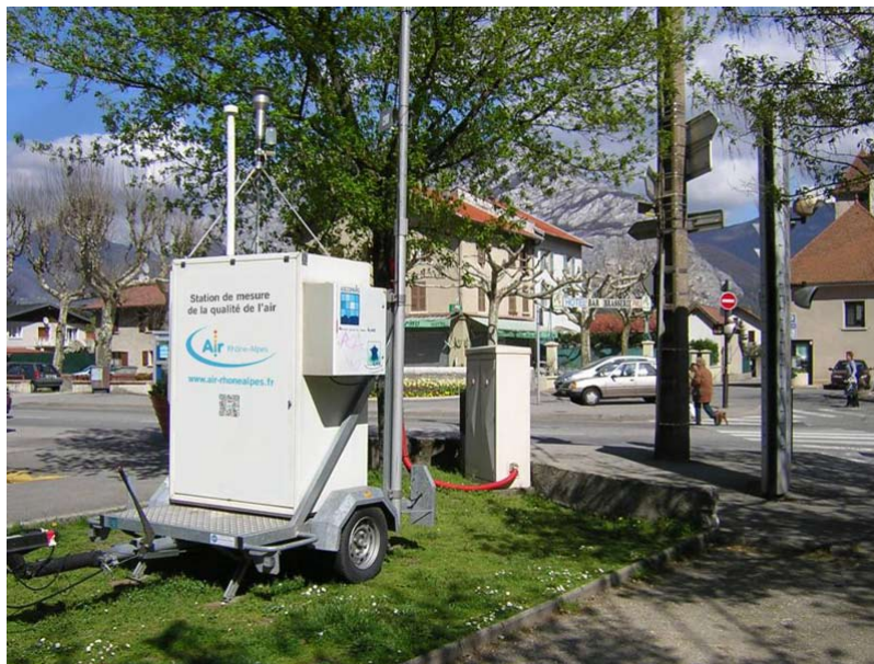
Figure 8. Station mobile en proximité trafic [Source : Atmo Auvergne-Rhône-Alpes : http://www.air-rhonealpes.fr/phototheque ]
