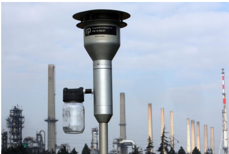
Figure 9. Appareil de mesure fixe sous influence industrielle [Source : Atmo Auvergne-Rhône-Alpes : http://www.air-rhonealpes.fr/phototheque ]
