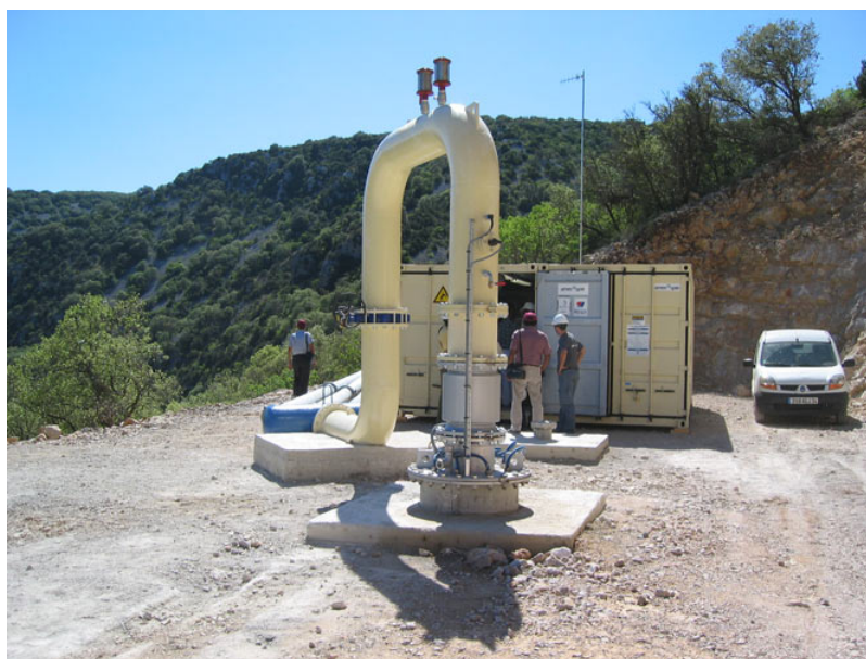
Figure 11. Test de pompage à fort débit, source des Cent-Fonts (Hérault). [Source : Photo M. Bakalowicz]
