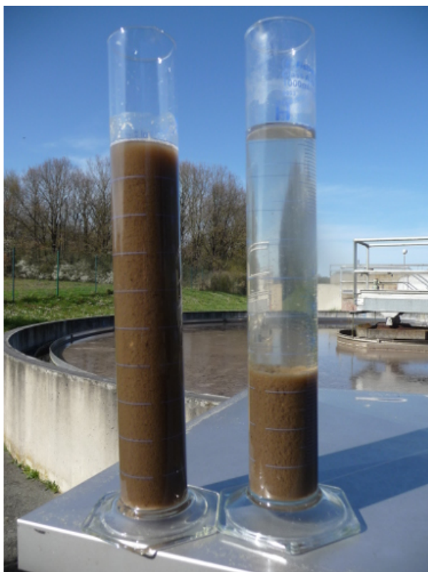
Figure 8. Echantillon de biomasse juste prélevé dans un réacteur à boue activées (éprouvette de droite) et après 30 minutes de décantation (éprouvette de gauche). Le surnageant représente l'eau traitée. [Source : © Joseph De Laat]
