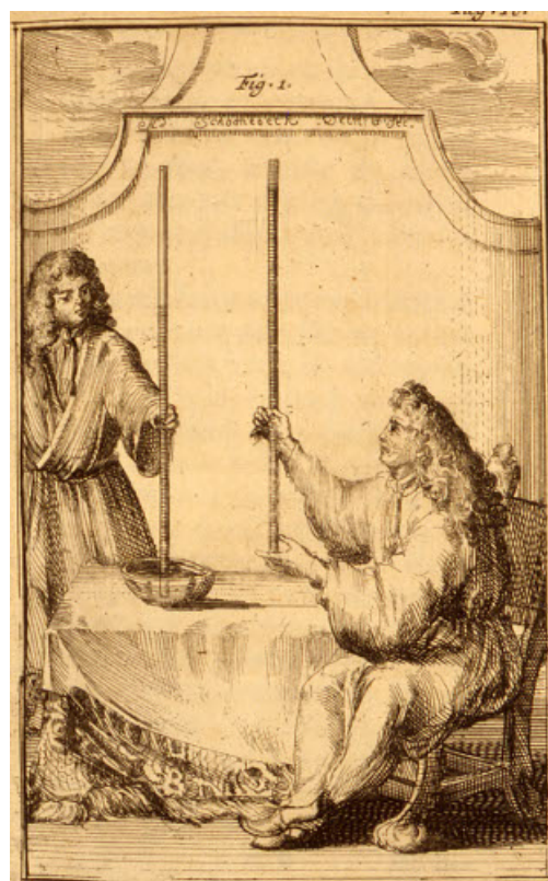
Figure 3. Torricelli et l'expérience du vide en 1643 [ Source : © D'ALENCE J. (1688) Traité des baromètres, thermomètres et notiomètres , Amsterdam].
