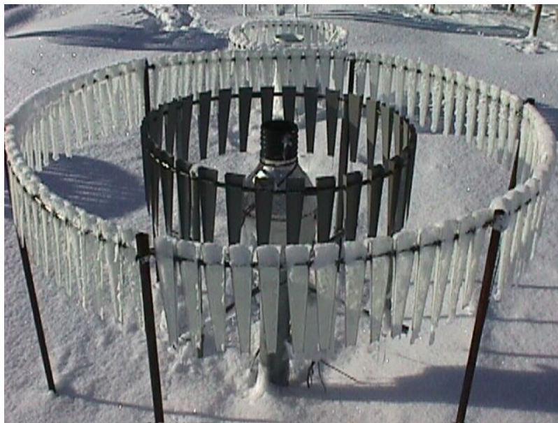
Figure 9. Pluviomètre protégé par un double écran de type Alter [Source : National Center for Atmospheric Research. http://www.rap.ucar.edu/projects/marshall/Events/19MAR98/MVC-021F.html ].
