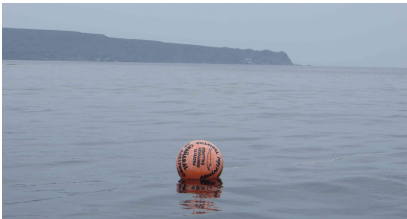
Figure 5. L'hydrophone fixe : une technique peu coûteuse et peu invasive pour explorer le paysage acoustique local. Ici, un appareil placé sur bouée, au nord du Chili. [Source : Cliché de l'auteur]
