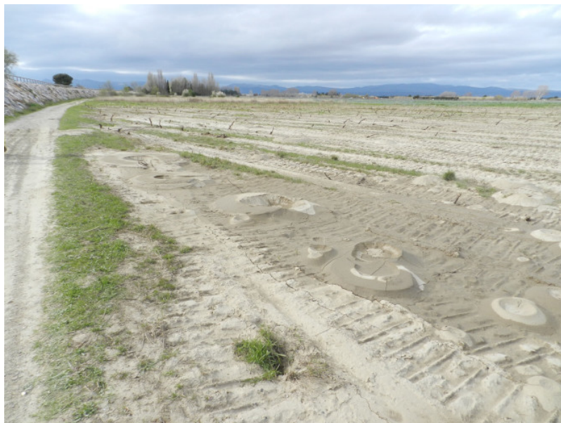
Figure 2. Exemple de tumulus de sable résultant d'un "sand boil" en aval d'une digue (digue de l'Agly, mars 2013) [Source : © P. Mériaux].
