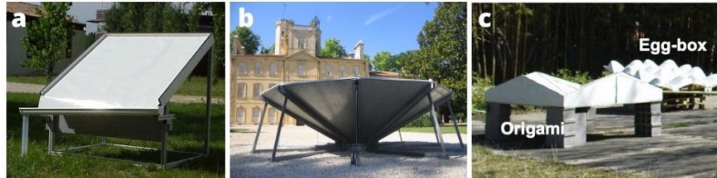
Figure 3. Divers collecteurs de rosée : a : Plan ; b : Cône [Source : Photo O.Clus] ; c : Origami et "egg-box" [Source : Photo D.Beysens].
