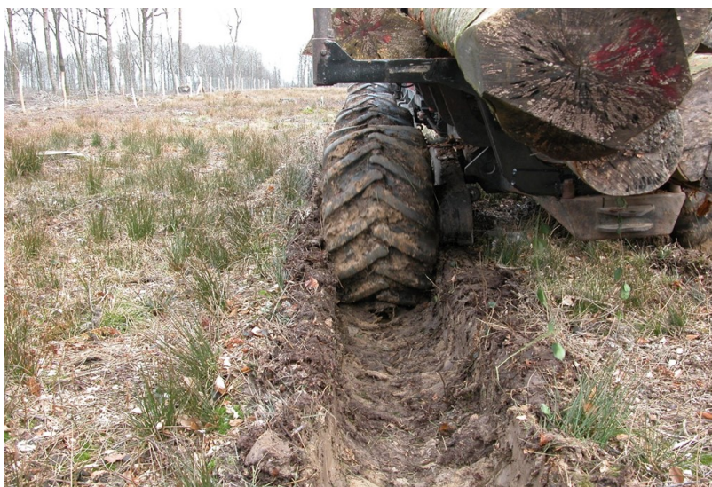
Figure 10. Orniérage occasionné par un débardage en milieu forestier. Les horizons profonds peuvent être affectés par un compactage irréversible. [Source : © Jacques Ranger]
