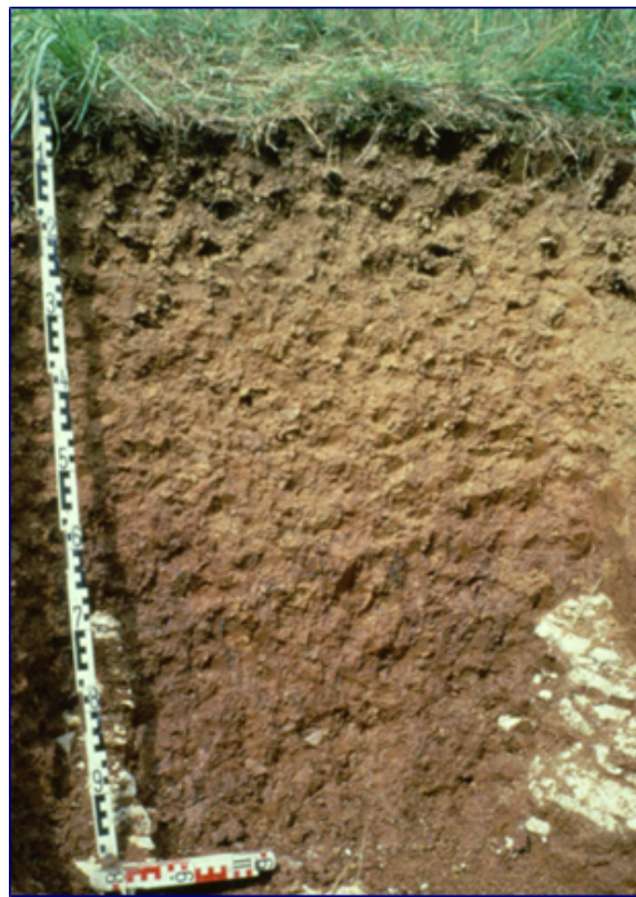
Figure 3. « Terre d'Aubue » de Basse Bourgogne. Sol non calcaire, moyennement épais (1 m), limono-argileux en surface, argileux en profondeur, développé dans une argile de décarbonatation (Yonne). [Source : © Denis Baize]
