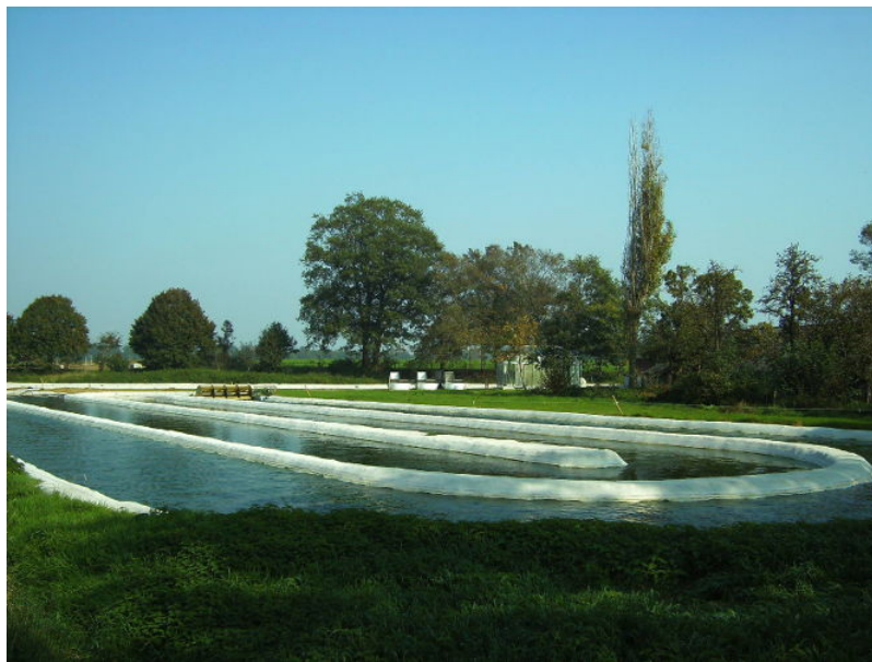
Figure 8. Bassin ouvert utilisé pour la culture de microalgues. L'eau est constamment maintenue en mouvement grâce une roue à palettes motorisée. [Source : By JanB46 [CC BY-SA 3.0], via Wikimedia Commons]
