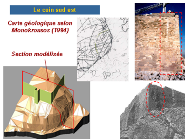
Figure 4. Modélisation numérique (par la « Méthode des Eléments Discrets ») de la stabilité du coin Sud-Est de l'Acropole d'Athènes [Source : Thèse de Doctorat de C. Lambert, coll. F. Darve, Grenoble INP.]
