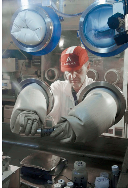
Figure 10. Boîtes à gant pour manipulation de produits radioactifs, usine de fabrication de combustible Mox. [source 102723 © LARRAYADIEU Eric / AREVA]
