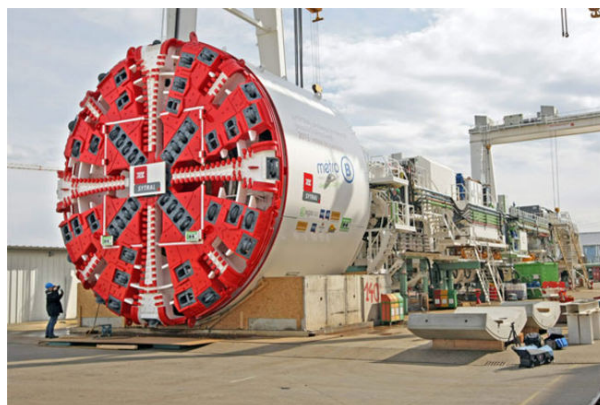
Figure 8. Exemple de tunnelier. Les tunneliers, sont de plusieurs types selon le sol traversé, à pression de terre, à pression de boue, à pression d'air. La pression est destinée à stabiliser le front d'abattage. Ce sont de véritables usines sur rails, extrêmement puissantes. Les principales parties sont essentiellement, dans l'ordre : la roue de coupe, le tapis de convoyage des déblais vers l'arrière, un bouclier si le sol est meuble, des vérins de réaction à la poussée sur la roue, la jupe d'échappement tronconique, l'érecteur de voussoirs (préfabriqués), des wagons de stockage. A l'extérieur une station de traitement de la boue si pression de boue. [source : © PHOTOPQR/LE PROGRES/PHILIPPON JOEL]
