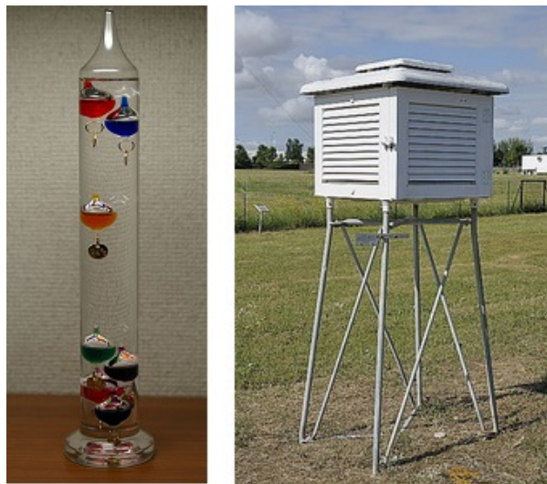
Figure 3. A gauche, thermomètre de Galilée [source : By Hustvedt (Own work) [CC BY-SA 3.0 ( http://creativecommons.org/licenses/by-sa/3.0 ) via Wikimedia Commons]. A droite, abri météorologique pour mesurer la température de l'air.
