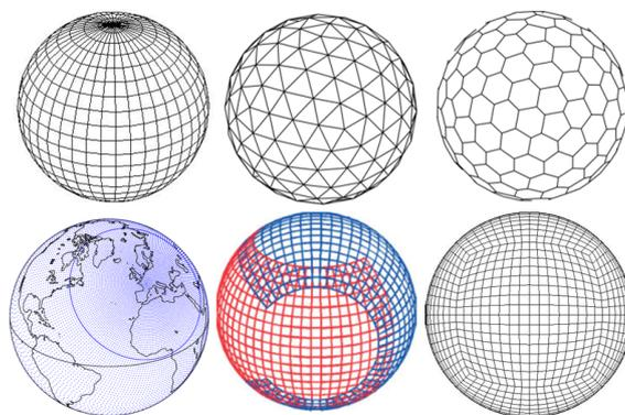
*Figure 4. Exemple de types de grilles horizontales utilisées par les modèles atmosphériques : grille régulière latitude/longitude actuellement utilisée par exemple au Met. Office au Royaume-Uni, grille triangulaire du modèle ICON en Allemagne, grille hexagonale, grille Gaussienne basculée et étirée du Modèle ARPÈGE de Météo-France, grille Yin-Yang utilisée au Canada, grille cube-sphère.*
