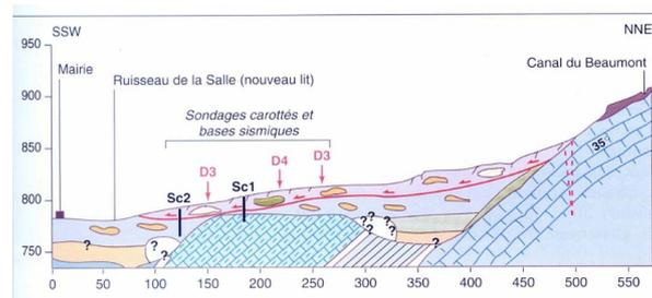
Figure 2. Coupe du glissement de La Salle en Beaumont, 2005. Le glissement s'est produit le 08/01/2004 le long de la surface en rouge dans des colluvions sur une surface de 7 ha et une épaisseur d'environ 10 m. Le glissement a barré la route RN85 et détruit partiellement le village causant 4 décès. [Source : Moulin & Chapeau, Voir ref. [2].]
