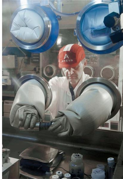
*Figure 10. Boîtes à gant pour manipulation de produits radioactifs, usine de fabrication de combustible Mox. [source 102723 © LARRAYADIEU Eric / AREVA]*
