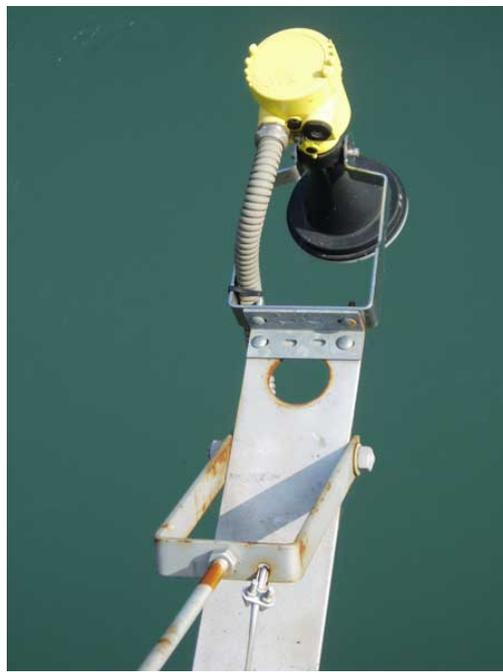
Figure 5. Mesure de niveau par radar émergé [Source : crédit photo EDF DTG].
