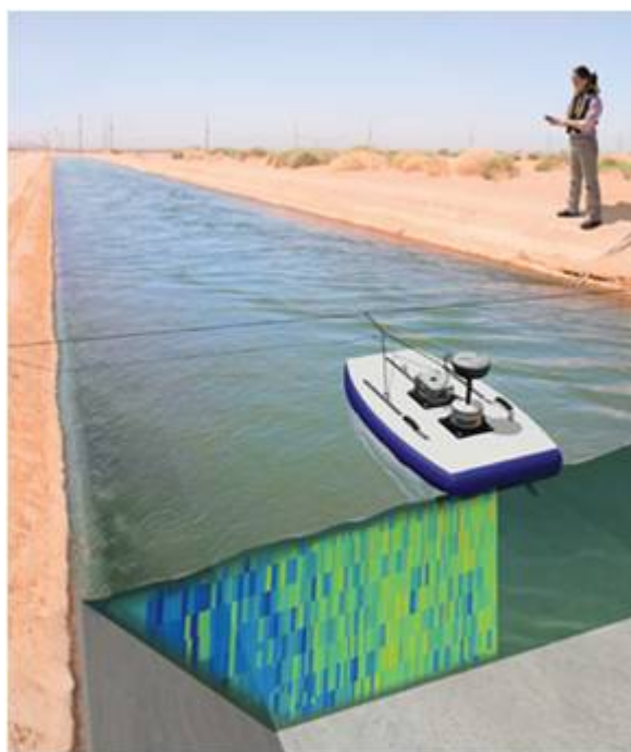
Figure 8. La mesure de vitesse par l'ADCP repose sur le principe du Doppler pulsé : émission d'impulsions ultrasonores dans l'eau et analyse du décalage fréquentiel de l'écho rétrodiffusé par les particules en suspension. Le dispositif comporte généralement 3 ou 4 transducteurs émettant des faisceaux acoustiques divergents autour de la verticale, ce qui permet de mesurer le profil vertical des vitesses en trois dimensions. [Source : crédit photo EDF DTG]
