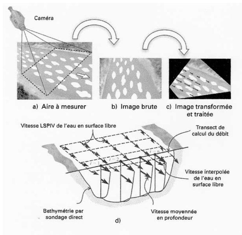
Figure 11. Principe de la LSPIV : a) ensemencement de corps flottants, b) enregistrement d'images, c) ortho rectification des images, d) calcul du débit à partir des mesures LSPIV de vitesse de surface (d'après Muste).
