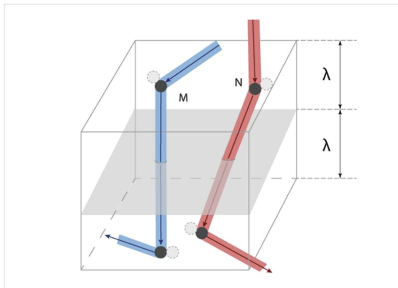
Figure 5. Volume situé de part et d'autre de l'unité de surface, permettant d'estimer à  $n\lambda$  le nombre de molécules qu'il contient et à  $nc/3$  le nombre de molécules qui, ayant eu leur dernière collision dans ce volume, vont traverser l'unité de surface. [Source : © René Moreau]
