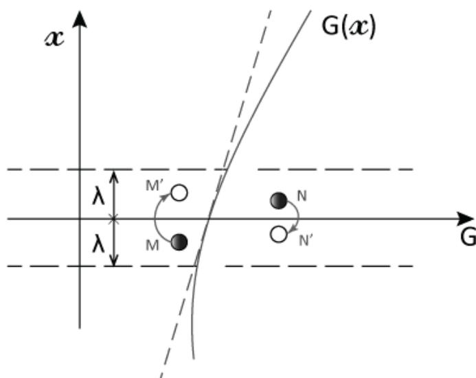
Figure 3. Une grandeur  $G(x)$  est distribuée de façon non-uniforme de part et d'autre d'une coupe plane  $x = 0$ . Les molécules comme celle partant de  $N$  et allant vers  $N'$ , qui viennent de  $x > 0$  transportent donc plus de  $G$  que celles venant de  $x < 0$  (comme  $M$ ). A l'échelle du libre parcours moyen  $\lambda$ , la fonction  $G(x)$  peut être remplacée par sa tangente (ligne droite en tirets). [Source : © René Moreau]
