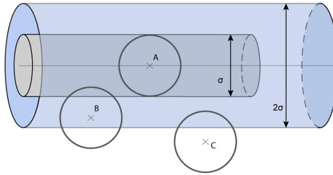
Figure 2. Pendant une unité de temps une molécule mobile A balaye un cylindre de diamètre  $\sigma$  et rencontre celles qui, comme B, ont leur centre à l'intérieur du cylindre de diamètre  $2\sigma$  et de volume  $c\pi\sigma^2$ , mais pas celles qui, comme C, ont leur centre en dehors de ce cylindre. [Source : © René Moreau]
