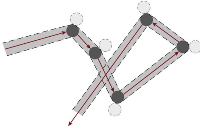
*Figure 1. Allure typique de la trajectoire en ligne brisée d'une molécule (cercle noir) et du volume qu'elle peut balayer. Chaque collision avec une autre molécule (cercles gris) provoque une réorientation de sa trajectoire. [Source : © René Moreau]*
