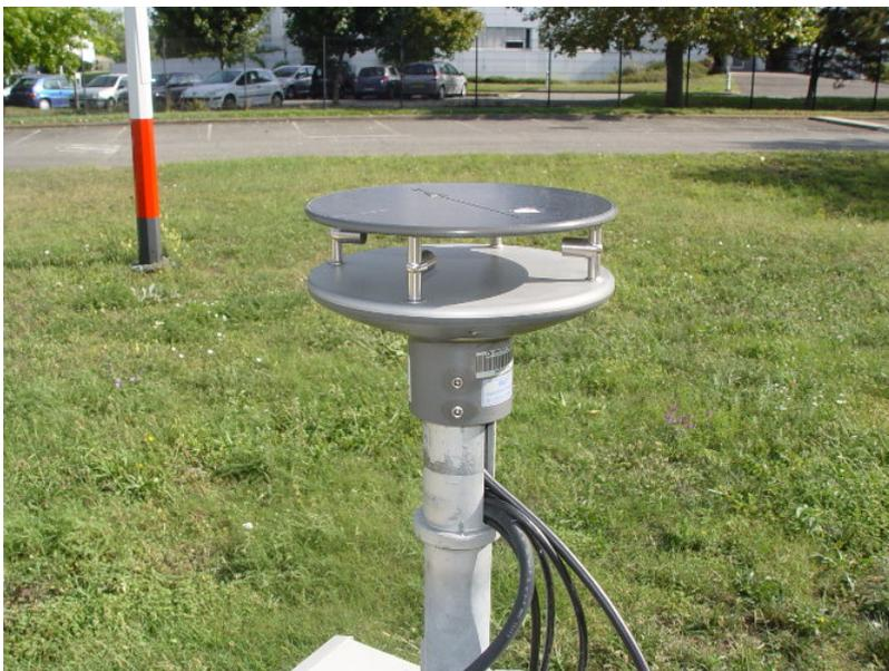
Figure 7. Exemple de capteur de vent à ultrasons [Source : © Lantuejoul Pierre – Météo-France]
