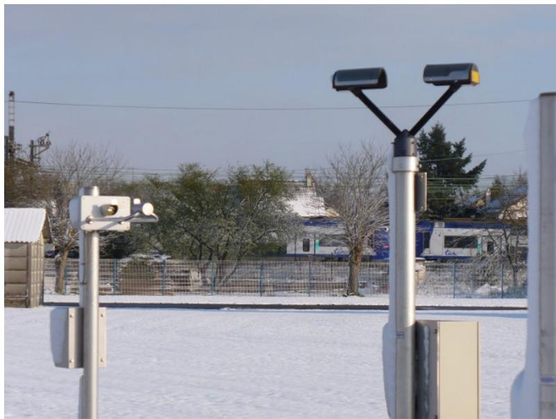
Figure 10. Disdromètres optiques [Source : © Michel Leroy]
