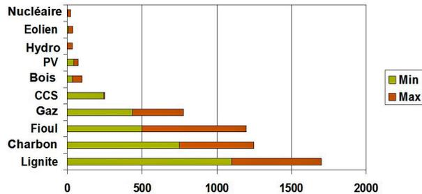
Figure 5. Émission de gaz à effets de serre de différentes sources d'électricité, exprimées en g de CO<sub>2</sub> par kWh. Les fourchettes Min et Max reflète des différences dans les méthodes d'évaluation [figure de Bertrand Barré à partir de données de D. Weisser, IAEA mai 2006]
