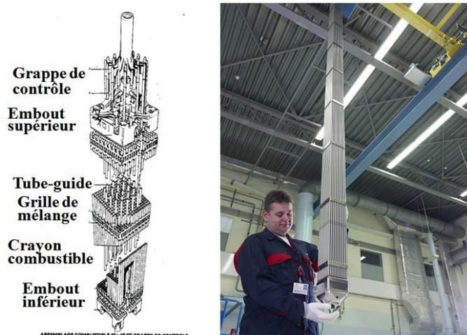
Figure 2. Assemblage du combustible nucléaire dans un réacteur à eau pressurisé (REP) [104366 /© AREVA / BRAUNE Michael]
