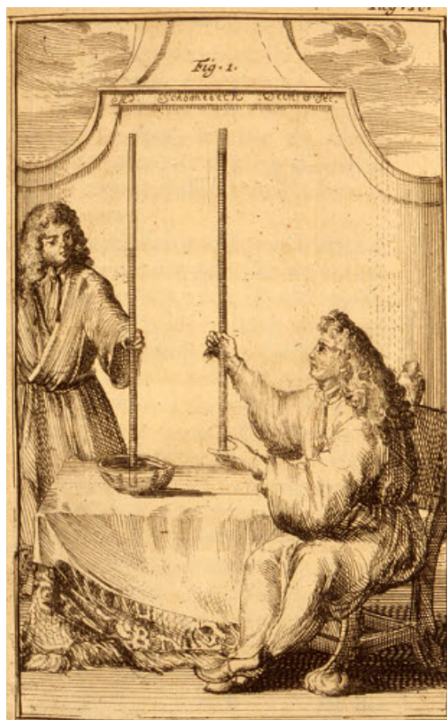
Figure 3. Torricelli and the experience of the vacuum in 1643. [© D'ALENCE J. (1688) Traité des baromètres, thermomètres et notiomètres , Amsterdam]
