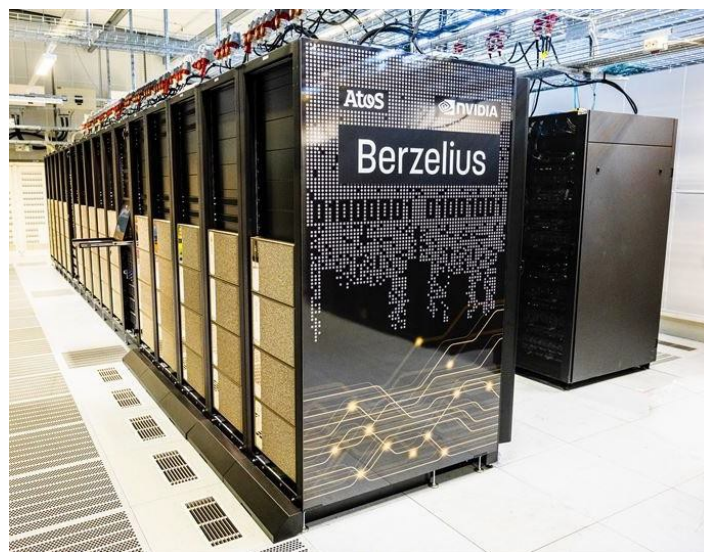
图 1. 贝采利乌斯超级计算机（以发现硅元素的瑞典化学家命名），位于瑞典林雪平大学，用于生命科学、机器学习和人工智能等领域的研究。该计算机于 2021 年启用，此后经过数次升级，算力提升至原来的两倍，目前其计算能力达 300 千万亿次 / 秒。[来源：图片 © Erik And30，知识共享署名 - 相同方式共享 4.0 国际许可协议，维基共享资源]
